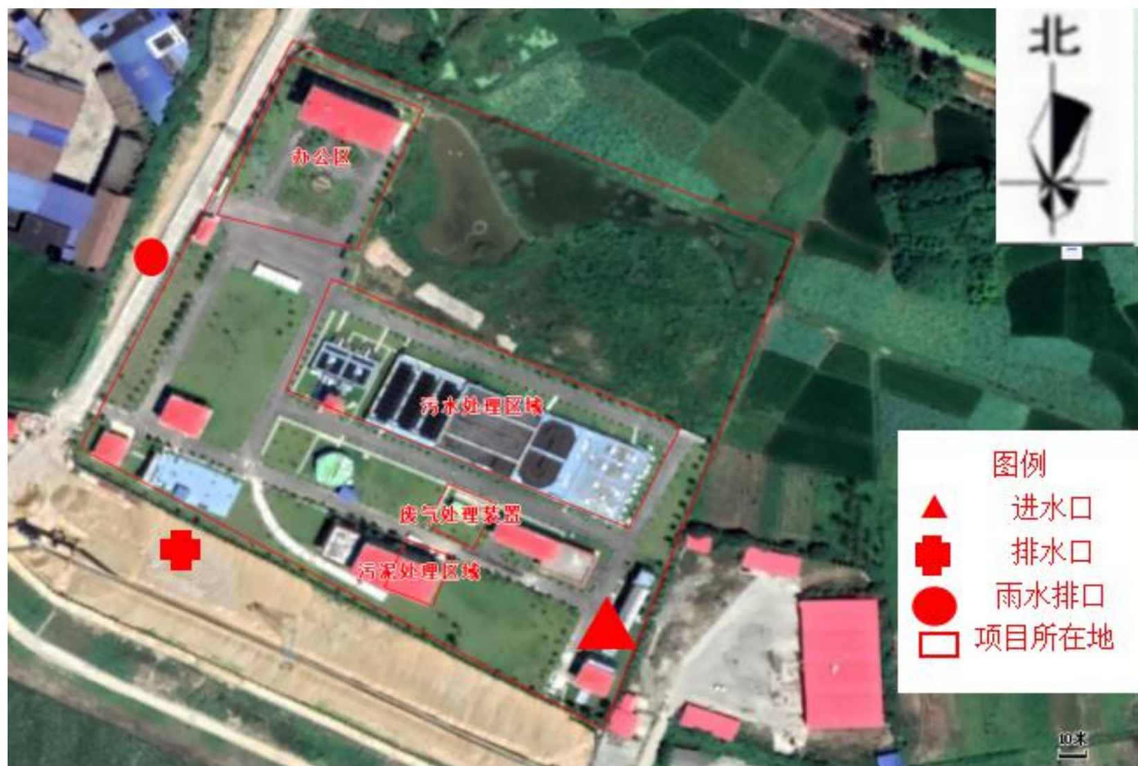
图 3-1 项目厂区平面布置示意图
